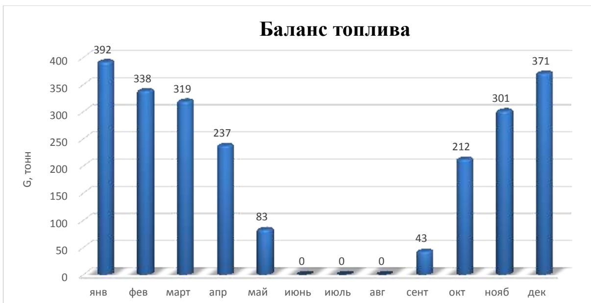
Рисунок 2.1.6.2.1 Топливный баланс котельной ЛПХ, тонн
