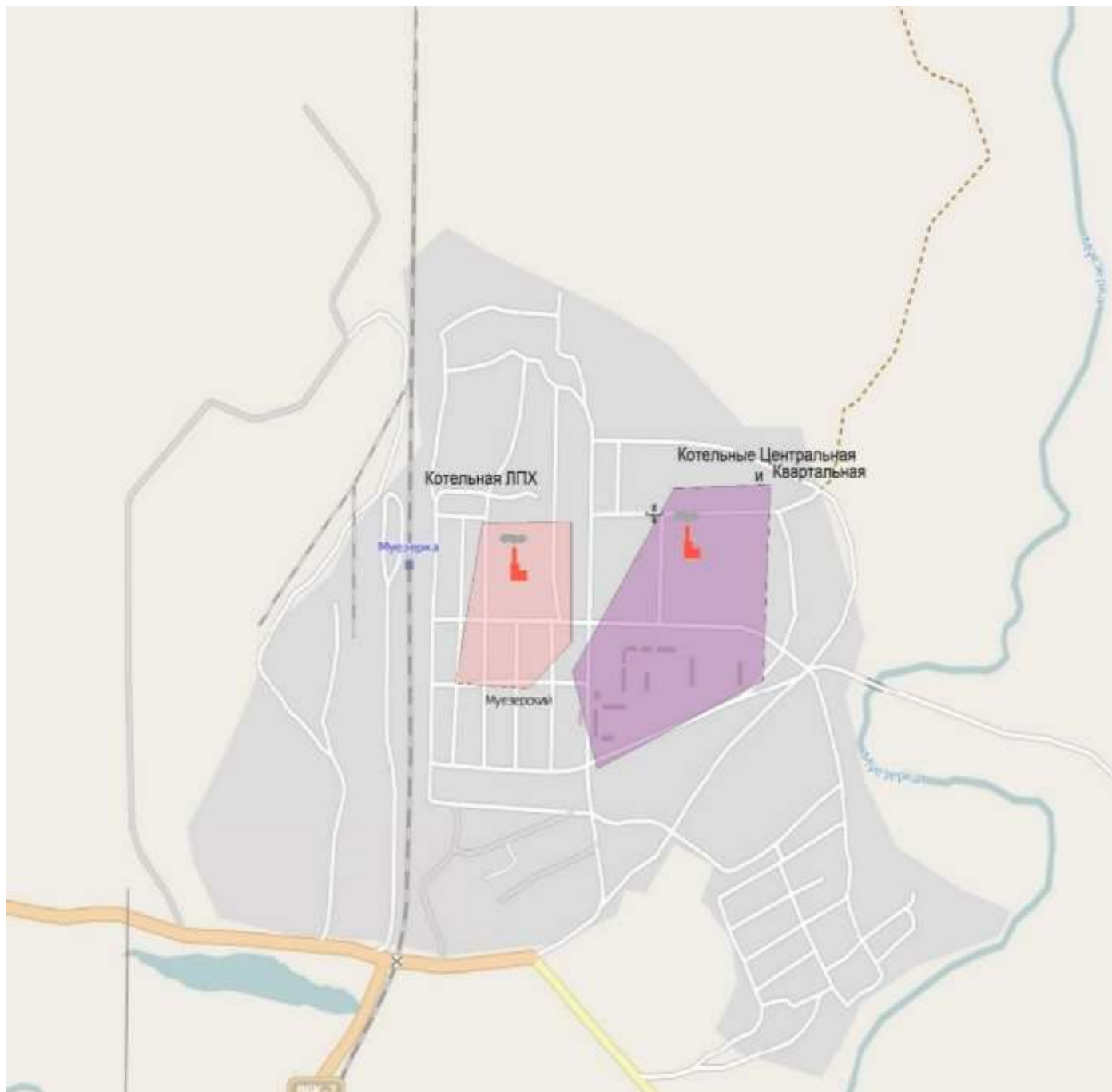
Рисунок 2.1.3.1 Зоны действия источников теплоснабжения п.г.т. Муезерский.
