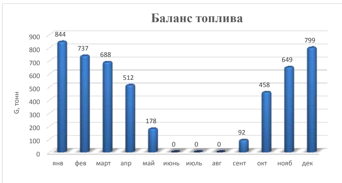
Рисунок 2.1.6.1.1. График расхода топлива Центральной и квартальной котельными.
